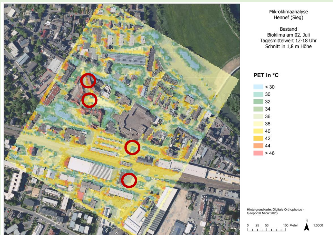
Abbildung 17: PET Bestand Innenstadt Hennef mit eingezeichneten Orten der simulierten Maßnahmen (rote Kreise).
