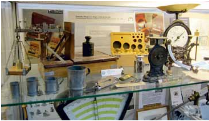
Abb. 5: „Gewichte, Waagen und Wägen im Wandel der Zeit“ – Dauerausstellung in der Meys Fabrik (kleine Stadthalle) in Hennef a. d. Sieg – weiter sind als „Nichtselbsttätige Waagen“ zu sehen: Dezimalwaage (links oben) Alois Quintenz, 1821. Bei der Dezimalwaage muss 1/10 der zu wiegenden Last als Gewichtsstück in die Waagschale gelegt werden. Um ein Gewicht von 1 kg abzuwiegen, benötigt man nicht mehr ein Gegenwicht von ebenfalls 1 kg – wie noch bei der gleicharmigen Balkenwaage –, sondern eines von lediglich 0,10 kg. Die abgebildete Dezimalwaage ist das Meisterstück eines polnischen Waagenbauers. Kazimierz Kacprzak schenkte dem Autor bei seiner Pensionierung diese Waage in Warszawa/Polen. Kacprzak war in leitender Position beim GUM (Główny Urząd Miar) in Warschau tätig. Älteste deutsche Briefwaage (rechts oben), handgefertigt nach dem Original von 1851. Eine „Haushaltswaage“ mit Federtechnik befindet sich direkt hinter der Briefwaage. „Haushaltswaagen“ sind Waagen mit geringer Genauigkeit zur Verwendung in Privathaushalten.
