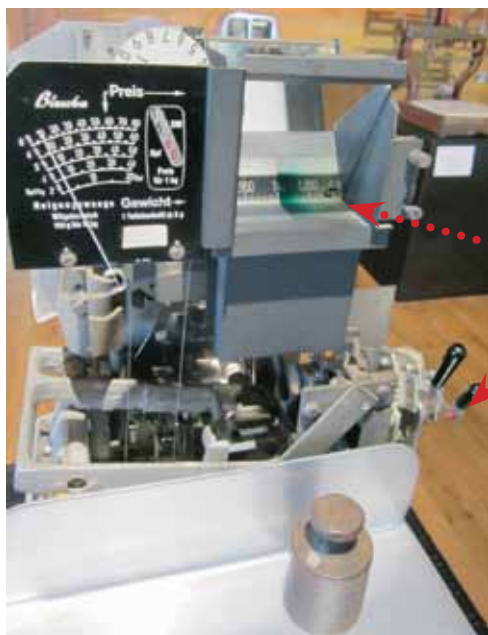
Doppelpendel-Neigungswaage mit optischer Preisanzeige (OP)
