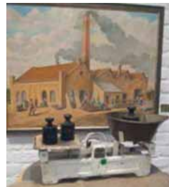
Abb. 2: Tafelwaage auf dem Prinzip der gleicharmigen Balkenwaage, um 1670
