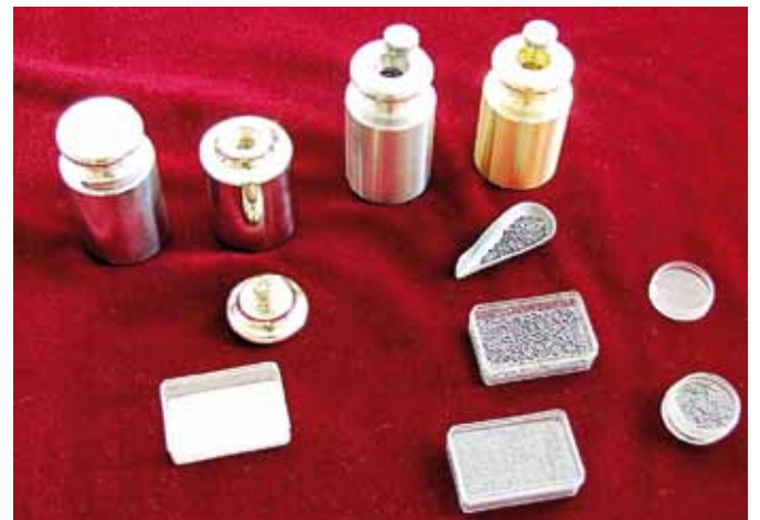
Abb. 4: Gewichtsrohlinge M1–M3 (rechts im Bild) mit Zubehör vor der Abschlussjustierung/Eichung. Die Präzisions- und Handelsgewichte (M1, M2, M3) werden in aller Regel mit einem Untergewicht gefertigt und sind mit einer Berichtigungskammer ausgerüstet. In diese Berichtigungskammer werden nun so viele kleine Bleikügelchen eingefüllt, bis einschließlich der Verschluss- bzw. Eichstempelplatte die vorgeschriebene Eichfehlergrenze erreicht ist.
