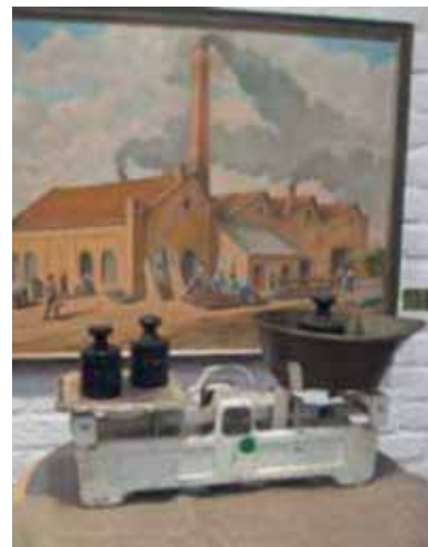
Abb. 2: Die Tafelwaage arbeitet nach dem Prinzip der gleicharmigen Balkenwaage.
