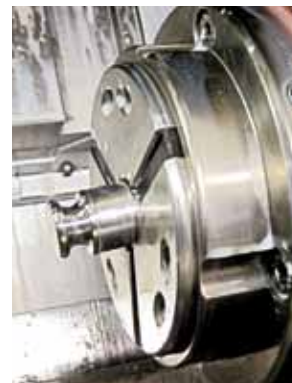
Abb. 2: Aus dem Rundstahl wird der Gewichtsrohling gedreht.
